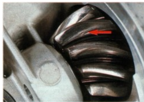
Pitting an einer Zahnflanke des Ritzels des Hinterradantriebes. Da es jedoch nur an einer Flanke auftrat, scheint ein Fremdkörper die Ursache zu sein
