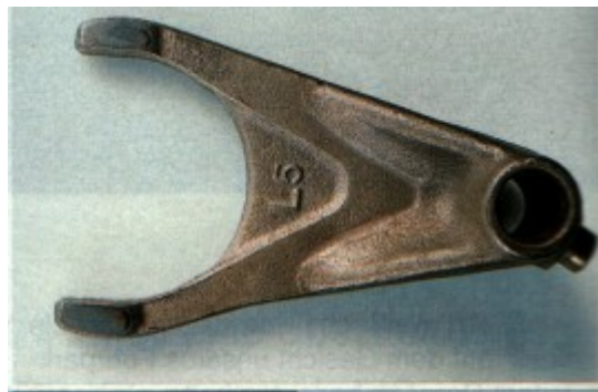
Die Schaltgabeln sind in fast neuwertigem Zustand. Nur leichte Druckspuren trotz der hohen Belastung, der sie ausgesetzt waren
