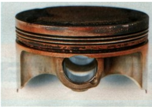
Die Kolben sind maßhaltig, am Feuersteg sind aber deutliche Reibspuren sichtbar. Leistungseinbußen waren bei der Abschlussmessung nicht festzustellen
