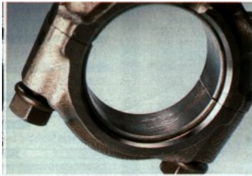
Sämtliche Pleuel- und Hauptlager sind maßhaltig. Das Pleuellager des dritten Zylinders zeigt jedoch starke Riefen und Laufspuren
