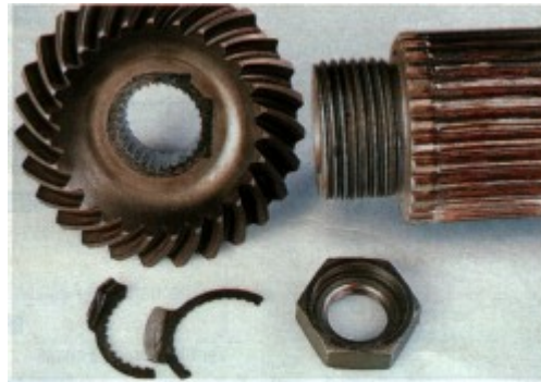
Das Sicherungsblech am Getriebeausgang ist gebrochen, die Mutter lose. Die Verzahnung von Kegelrad und Vorgelegewelle ist ausgeschlagen
