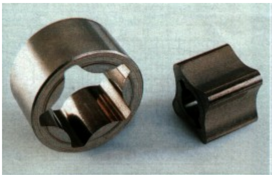
Innen- und Außenrotor der Ölpumpe sind in gutem Zustand. Nur die Anlaufflächen weisen leichte Riefen auf
